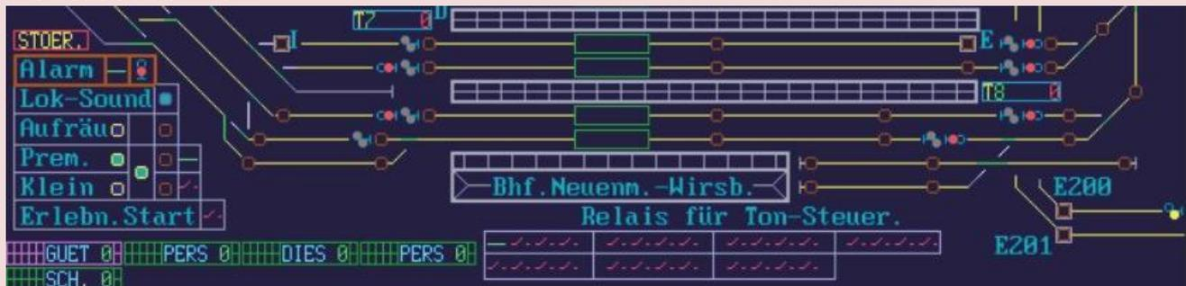
Wenn Sie die neue Relais-Karte eingebaut haben und wenn Sie die Alarm-Funktion über den "Not-Halt-Parameter" in der Datei S88.INT aktiviert (eingeschaltet) haben, dann wird bei Auslösen eines Alarms zusätzlich zum Alarm-Signal auch das höchste Relais eingeschaltet (Relais zieht an). Damit lässt sich der Alarm noch wesentlich schneller nach draußen melden, weil es keine Schalt-Verzögerungen durch das Digitalssystem gibt.
