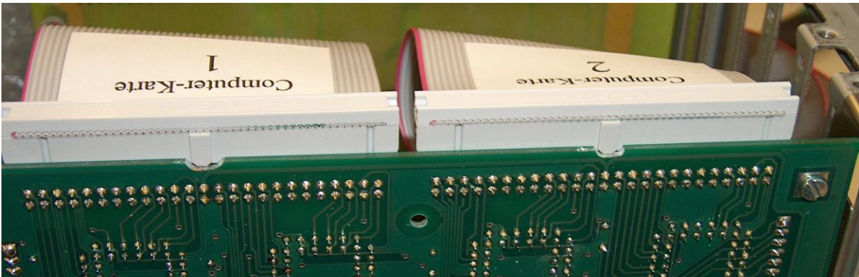
Die gleiche KOMPL-96-PCI von der Lötseite betrachtet. Für die „Führungsnasen“ der Flachbandkabel-Stecker gibt es entsprechende Ausfräsungen auf der Platine.
