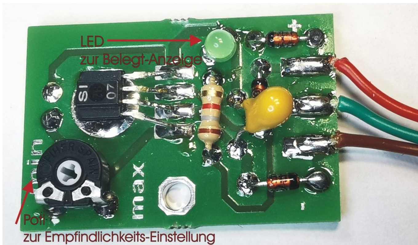
Blick auf die Unterseite der REFLIS-Poti
