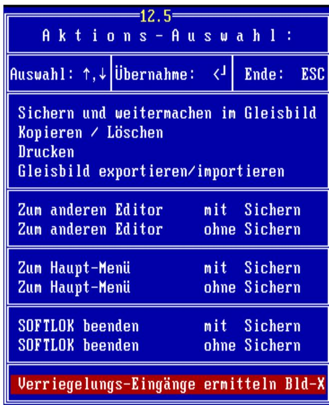
Über den Menüpunkt „**Verriegelungs-Eingänge ermitteln**“ können Sie „auf Tastendruck“ für alle bisher von Ihnen in allen **6 SOFTLOK-Gleisbildern** eingegebenen Block-Strecken (mit mindestens 1 Block-Linie) die Blockstrecken-Verriegelungs-Eingänge ermitteln lassen.
