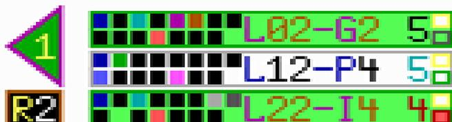
Links vom inneren Datenfeld der Lok-Box befinden sich – in 2 Reihen - 15 Funktionsfelder für die Lok-Funktionen **F1 – F15** (F1 – F8 in der oberen Reihe und F9 - F15 in der unteren Reihe).
