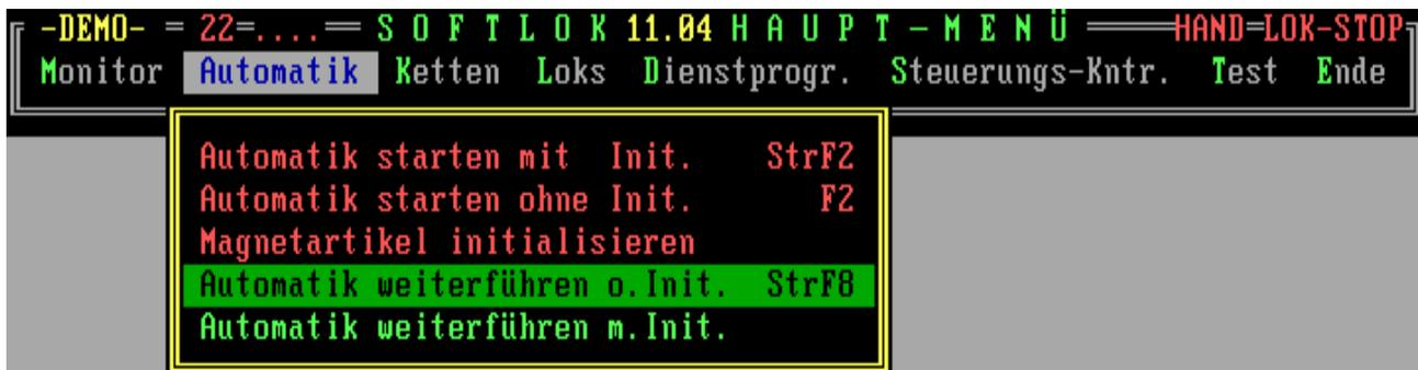
Ein „*normaler*“ Start der Automatik ist zu diesem Zeitpunkt nicht möglich! Die Funktion Automatik unterbrechen kann nur fortgesetzt werden mit der Funktion Automatik weiterführen.
